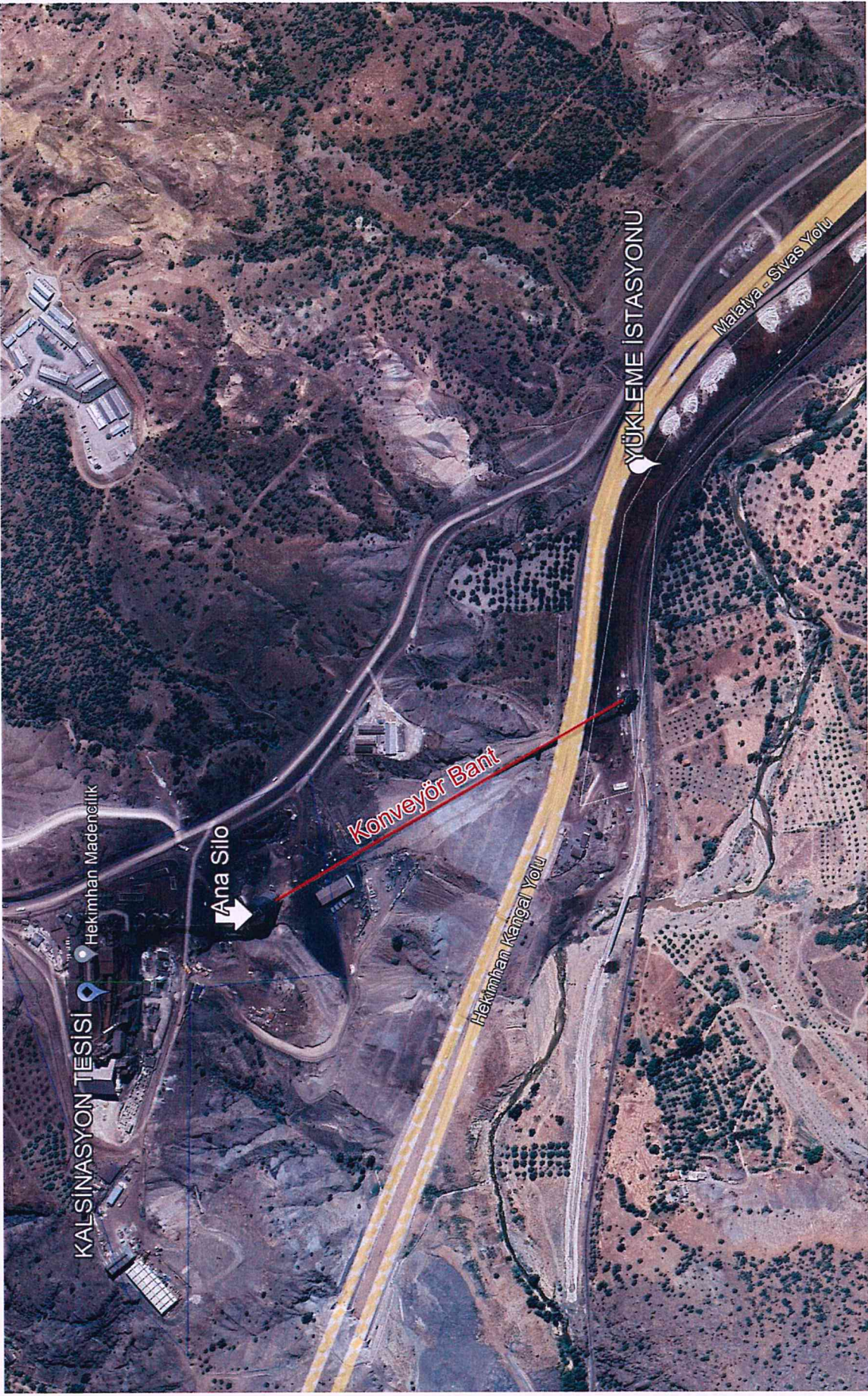
Şekil 15. Hekimhan Siderit Kalsinasyon Tesisi-Karakışık Yükleme Depolama Alanı Konveyör Bant Güzergahı
